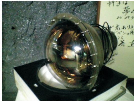
図 2.5 衝撃波防止ケースに収められた 20 インチ PMT
