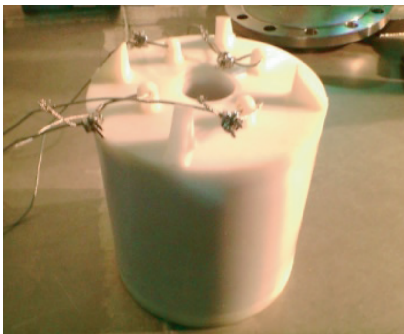
図 3.34 QE 測定に使われる光源の写真:直径 20cm
