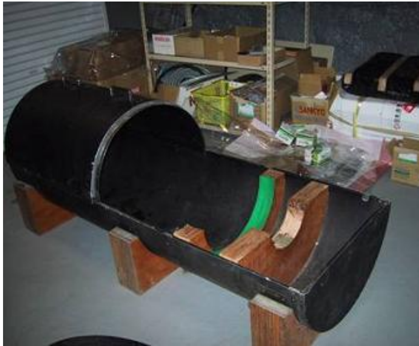
図 3.10 PMT の外を覆う暗箱:μ メタル製
